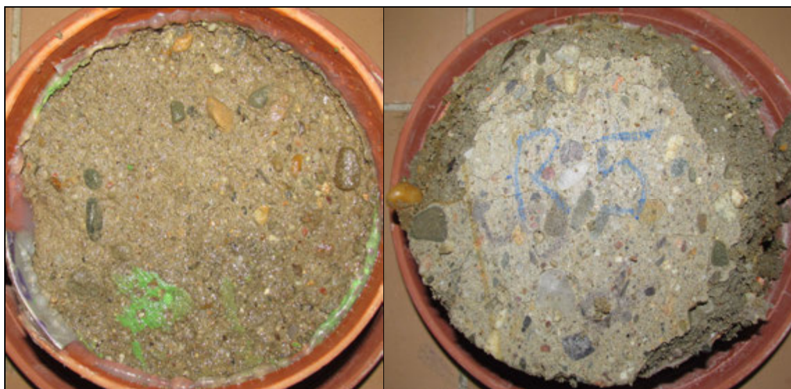
Foto 4: Pohled na čelo a dno vývrtnu V5 – po CH.R.L. - metoda C – 75 cyklů
