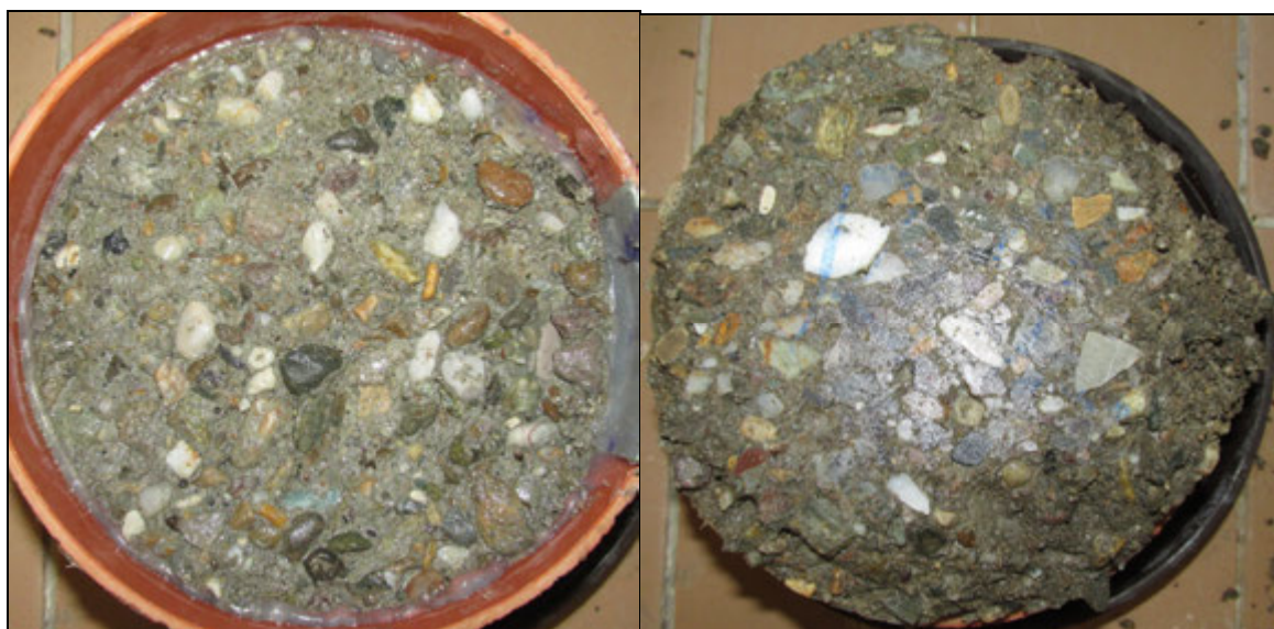
Foto 2: Pohled na čelo a dno vývrtu V2 – po CH.R.L. - metoda C – 100 cyklů
