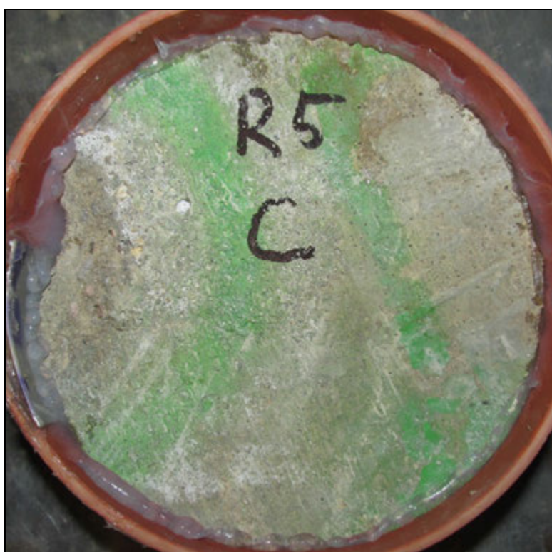
Foto 3: Celkový pohled na čelo vývrtu V5 před zkouškou
